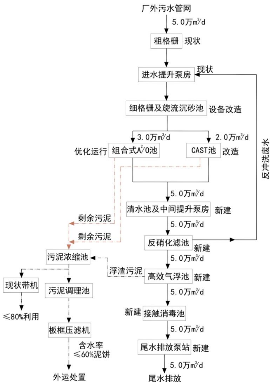
图 7.2-1 无锡钱惠污水处理有限公司提标改造后工艺流程图
